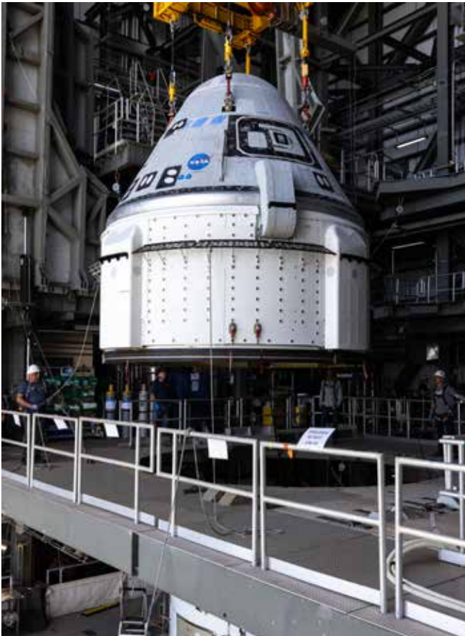
↑ CALYPSO: Starliner-fartøyet Calypso heises på plass på bæreraketten Atlas 5 i april 2024. Fartøyet består av besetningsmodulen (grå) og servicemodulen (hvit). Utvekstene på servicemodulen huser stillingskontrollmotorene. (Foto: NASA)
