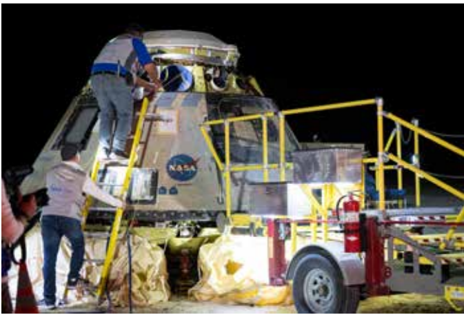
↑ LANDING: Teknikere fra Boeing arbeider med Calypso etter landingen ved White Sands Space Harbor 7. september 2024. Under Calypso skimtes to av de seks luftputene som sikret en myk landing. (Foto: NASA)
